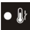
Sygnalizacja przegrzania się urządzenia (zabezpieczenie termiczne): wewnątrz urządzenia została osiągnięta zbyt wysoka temperatura. Urządzenie jest włączone ale nie wytwarza prądu dopóki nie uzyska zwykłej temperatury. Reset następuje automatycznie.
