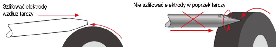
Rys. 24. Szlifowanie elektrody wolframowej
